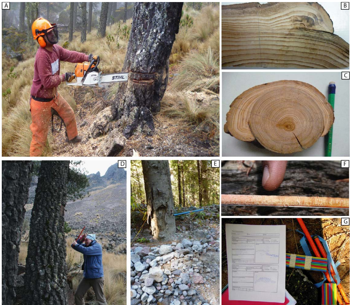
Figura 3.3. Herramientas para el muestreo dendrogeomorfológico en campo. Colecta de árboles con motosierra (A), se pueden extraer cuñas (B) y secciones transversales (C). Otra manera para muestreo de árboles es por medio de barrenos Pressler (D y E) para obtener núcleos de madera (F) y de este modo impactar lo menos posible al bosque. (G) Tratamiento de núcleos de madera en campo y formato de llenado para la información dendrogeomorfológica del sitio de estudio.
