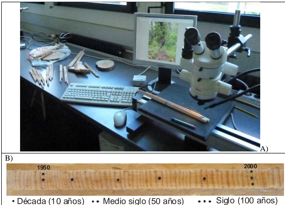
Figura 3.6. A) Estación de conteo y medición de anillos de crecimiento Leica- LINTAB. B) Conteo de núcleos de madera.
