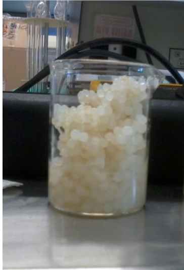
Figura A.3. Medio de soporte colmatado de biomasa. Fotografía tomada durante proceso de mantenimiento semanal. Marzo, 2014.
