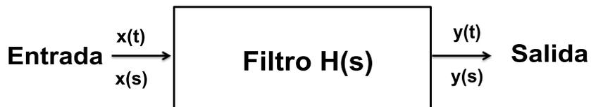
Figura 4.1. Representación simbólica de un filtro.
