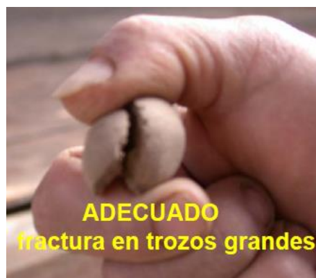
Imagen 23. Si se revienta la bolita en trozos grandes es adecuada la tierra pero si se pulveriza no es recomendable construir tapias con ella.
