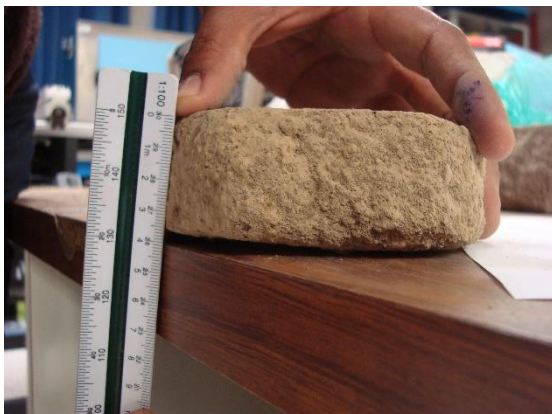
Imagen 217. Toma de medidas de las muestras antes de realizar las pruebas de compresión en las muestras obtenidas.
