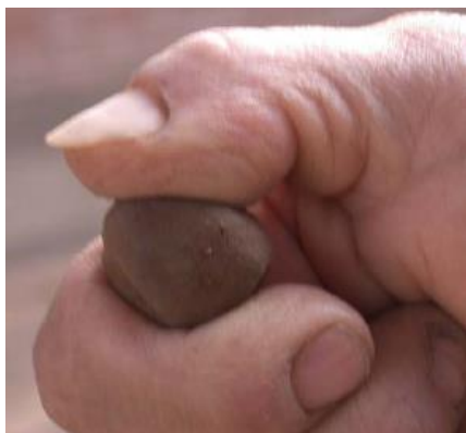
Imagen 22. Prueba de la bolita en la tierra, en la que se hace una bola de aproximadamente 4 cm de diámetro con tierra húmeda y se comprime.
