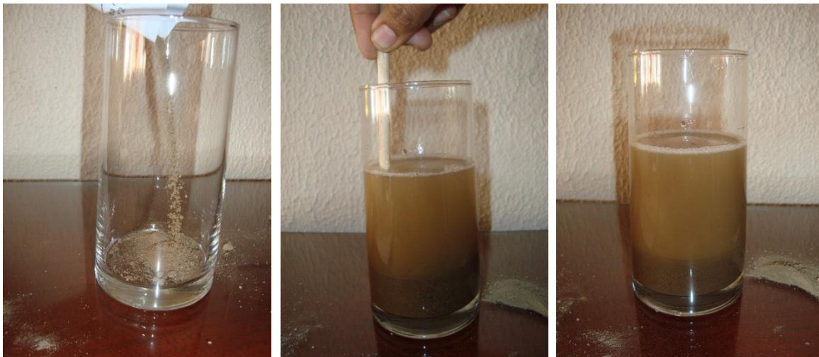
Imagen 222. Procedimiento de la segunda prueba de las muestras obtenidas para conocer las propiedades de la tierra, compuesta de arena, limo y arcilla.
