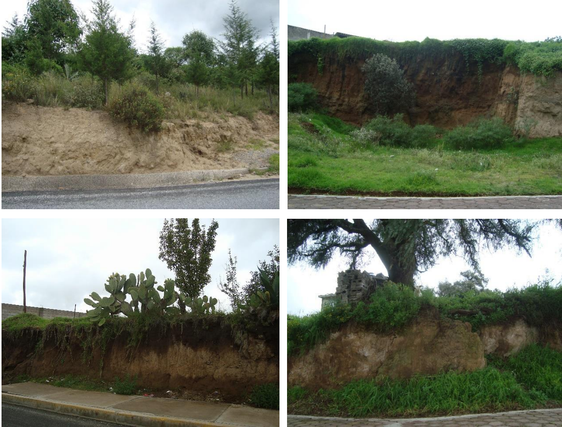
Imagen 214. Existencia de materia prima en los terrenos e inmediaciones de las haciendas para la erección de muros de tapia a base de la compactación de tierra.
