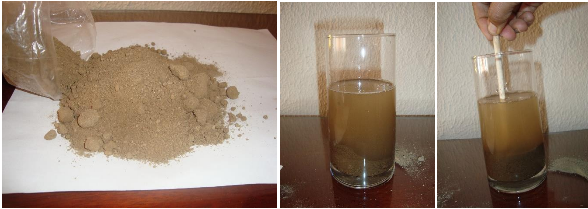
Imagen 223. Realización de prueba de propiedades de la tierra obtenida de la edificación de un muro nuevo en la hacienda San Francisco Soltepec. Fuente: Imágenes de autor.
