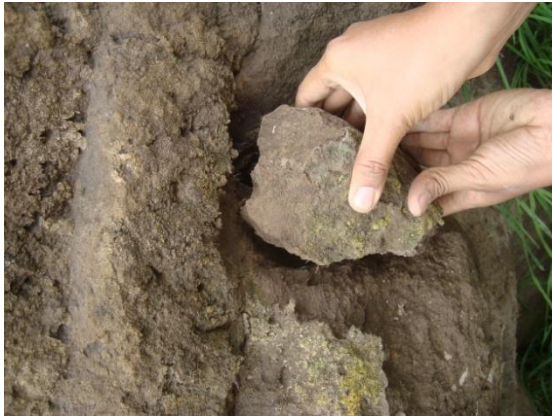
Imagen 215. Obtención de muestras para análisis de la composición de la tierra y resistencia a la compresión en una sección de muro de tapia en ruinas en la hacienda Santa Teresa Ixtafayuca, Nanacamilpa, estado de Tlaxcala.
