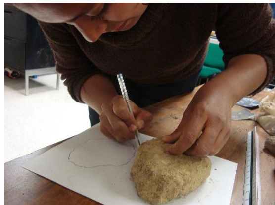
Imagen 217. Toma de medidas de las muestras antes de realizar las pruebas de compresión en las muestras obtenidas.
