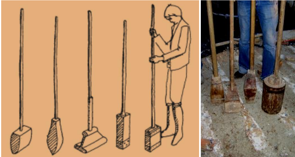
Imagen 25. Pisones utilizados para compactación manual, pison de dos cabezas sugerido para apisonar la tierra en el muro de tapia.
