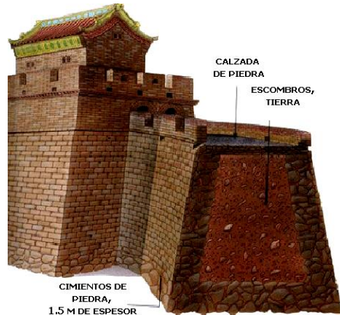
Imagen 9. Esbozo del sistema constructivo empleado en la Muralla China. Fuente: La gran muralla china: Historia y características en: http://www.taringa.net/posts/apuntes-y-monografias/11457705/La-gran-muralla-china_-Historia-y-caracteristicas.html (2014)
