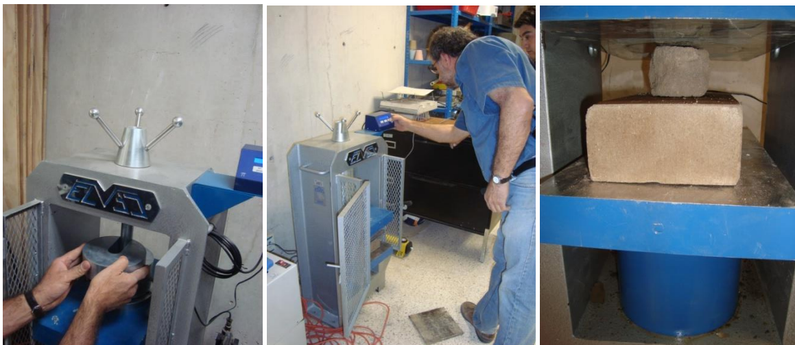
Imagen 218. Pruebas de compresión a las muestras de tapia.
