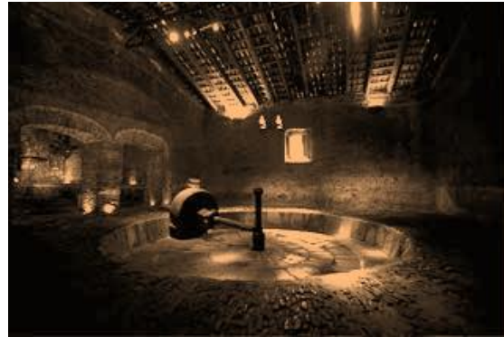
Imagen 106. Molino de piedra (hacienda San José del Refugio, Jalisco) para la molienda de la piña de agave azul, una vez que pasó por el proceso de cocción.
