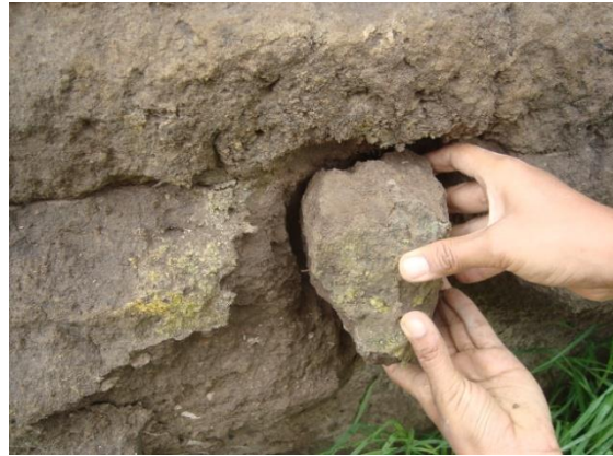
Imagen 215. Obtención de muestras para análisis de la composición de la tierra y resistencia a la compresión en una sección de muro de tapia en ruinas en la hacienda Santa Teresa Ixtafayuca, Nanacamilpa, estado de Tlaxcala.
