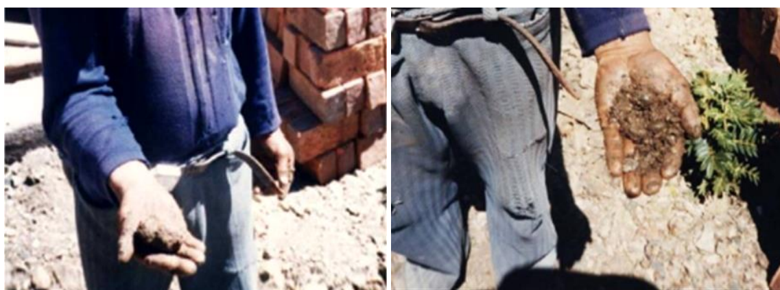
Imagen 18. La primera imagen muestra la tierra adecuada para la edificación de muros de tapia por la ausencia de materia orgánica, mientras que en el segundo caso se aprecia la tierra con componentes de origen vegetal.
