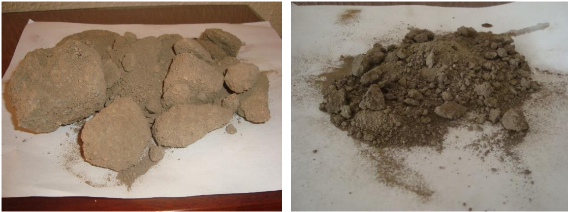
Imagen 221. Sección del muro disgregado después de aplicar la prueba de compresión en las muestras obtenidas, el cual sirve para la aplicación de la siguiente prueba.
