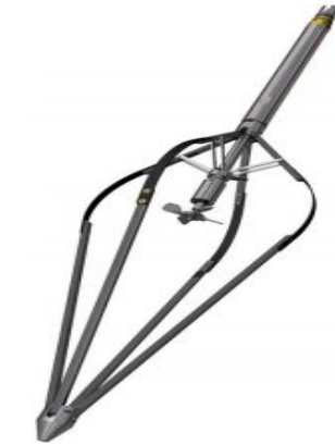
Figura 2. 31. Medidor de flujo de caudal total.
