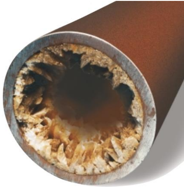
Figura 3. 12. Formación de Incrustaciones en tubería, Oilfield Review 20 . Schlumberger.
