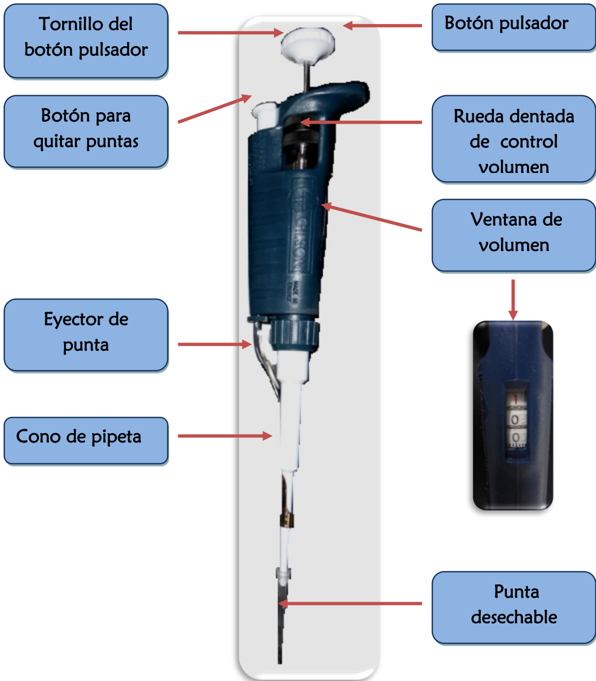
Fig. 14 Esquema de las partes que componen un micropipeta de la marca Gilson®.
