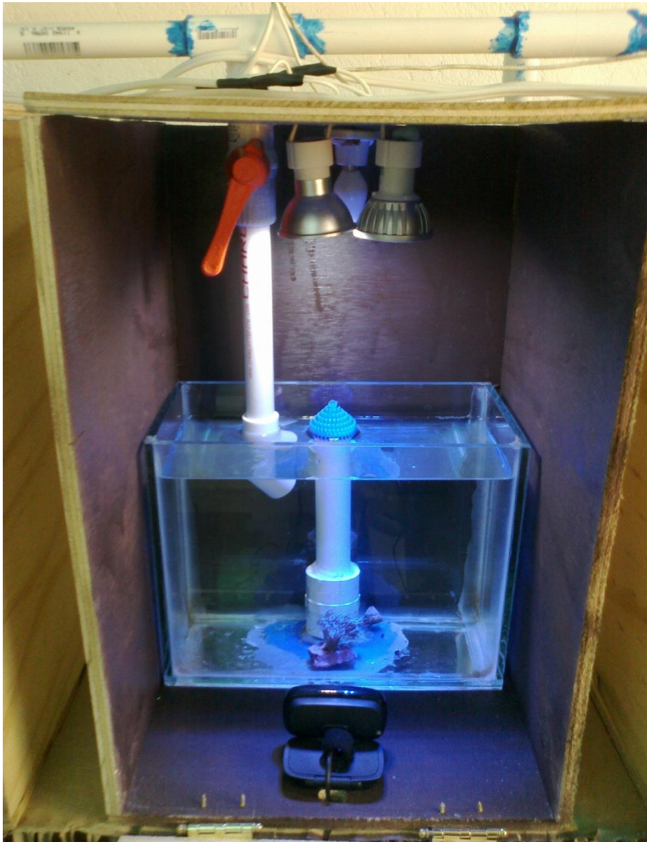
Fig. 1A Sistema de focos LED blanco y azul, insuficientes en espectro e intensidad.
