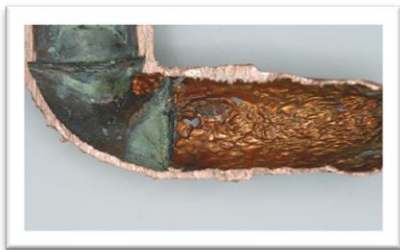
Figura 2. Corrosión en una tubería.
