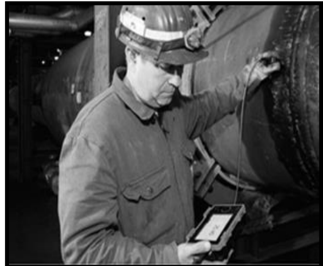
Figura 2.11 Medición ultrasónica de espesores en una línea. (ILog, S.A. DE C.V.)
