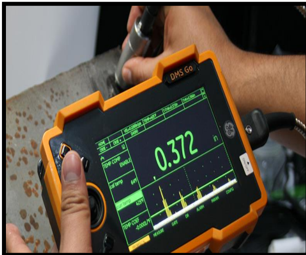
Figura 2.10 Sistema de inspección ultrasónica (ILog, S.A. DE C.V.)
