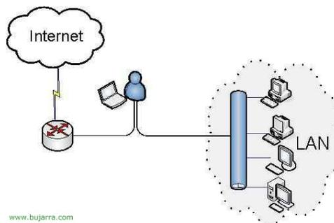
Figura 30. Funcionamiento básico de la técnica Man-in-the-Middle.
