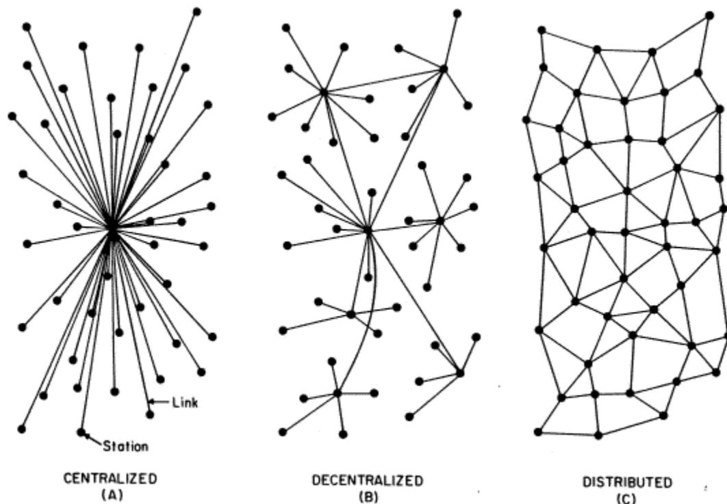
Figura 3. Redes centralizadas, descentralizadas y redes distribuidas.
