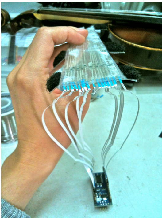
FIG. 24. IZQUIERDA PLANTILLA CONECTADA AL ARDUINO. DERECHA PLANTILLA SOBRE EL VIOLÍN
