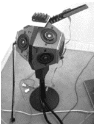
FIG. 11. A LA IZQUIERDA EL BOSSA (BOWED-SENSOR-SPEAKER-ARRAY). A LA DERECHA EL DIAGRAMA CON ALGUNOS DE LOS SENSORES QUE CONTIENE EL BOSSA.
