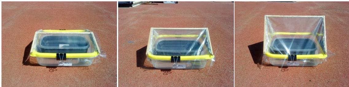
**Figura 2.1. Prototipos empleados para la determinación de la inclinación del condensador.**
