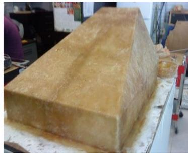
**Figura 3.7. Aplicación de la fibra de vidrio.**
