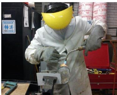
**Figura 3.27. Proceso de soldado del cilindro de aluminio.**
