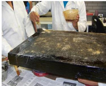
**Figura 3.21.** Aplicación de la fibra de vidrio al evaporador.
