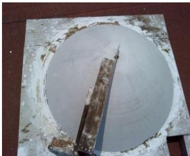
**Figura 3.15. Molde del paraboloides.**
