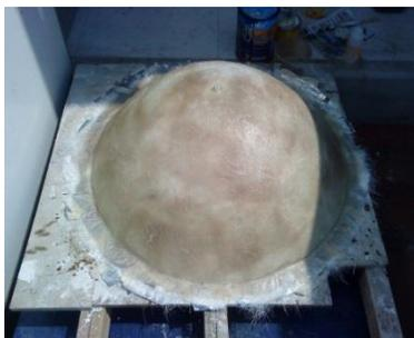
**Figura 3.16. Aplicación de la fibra de vidrio.**
