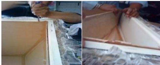
**Figura 3.8. Extracción del molde.**
