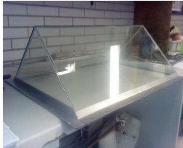
**Figura 3.4. Condensador.**
