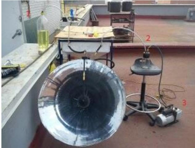
**Figura 4.8. Pasos para crear el vacío en el sistema.**
