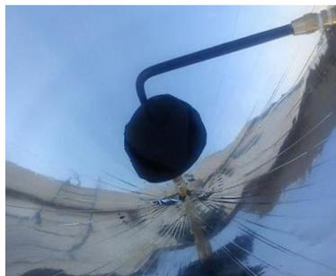
**Figura 3.26. Prueba experimental del depósito de aceite construido con cobre.**
