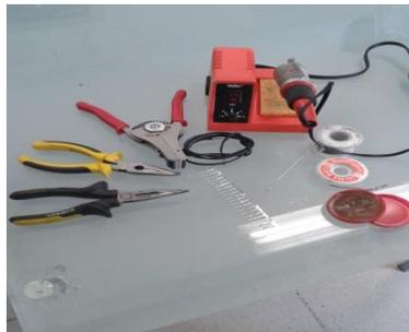
**Figura 4.1. Material utilizado para la manufactura de los termopares.**
