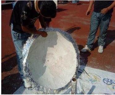
**Figura 3.17. Extracción del paraboloid.**
