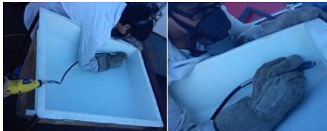
**Figura 3.11. Perforaciones del depósito.**
