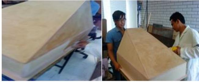
**Figura 3.6. Molde del depósito.**
