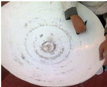
**Figura 3.18. Lijado del paraboloid.**
