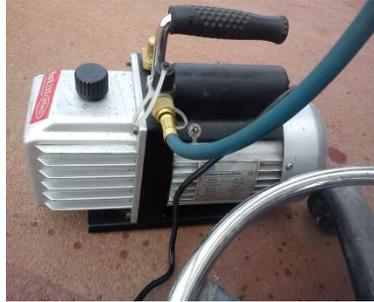
**Figura 4.6. Bomba de vacío.**
