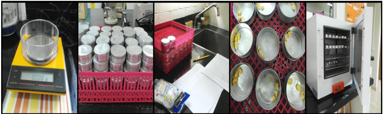
Figura 2.3 Determinación de humedad del maíz blanco en una estufa Lindberg Blue Modelo: TS7182W87
