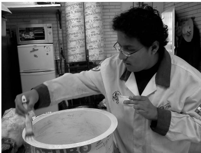
**Figura 6.1.- Aplicación de gel-coat al premolde.**
