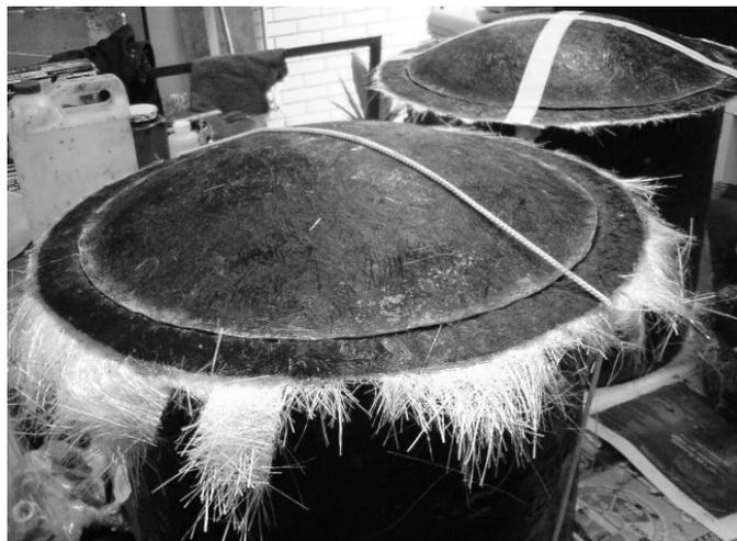
**Figura 6.9.- Piezas de la tapa colocada para ser unidas con más resina y fibra de vidrio.**
