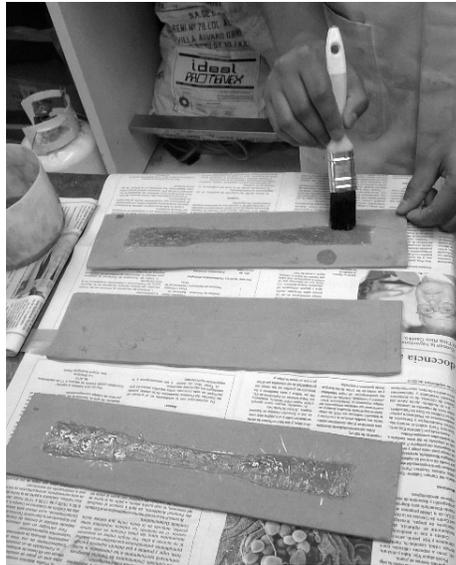
**Figura 4.3.- Fabricación de las probetas para el ensayo de tensión.**
