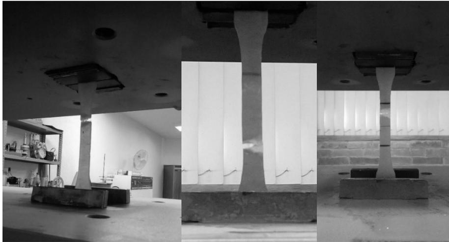
**Figura 4.6.-Rotura de las probetas 1, 2 y 3 de izquierda a derecha.**
