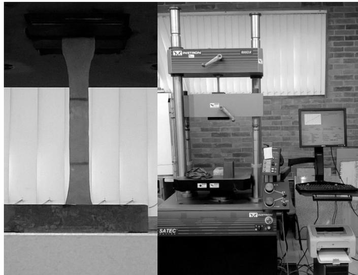
**Figura 4.5.- Ensayo de tensión de las probetas.**
