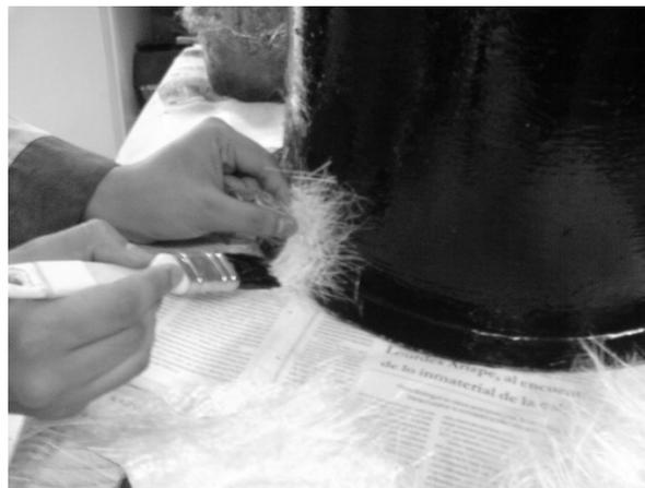
**Figura 6.4.- Aplicación de fibra de vidrio sobre la pieza.**
