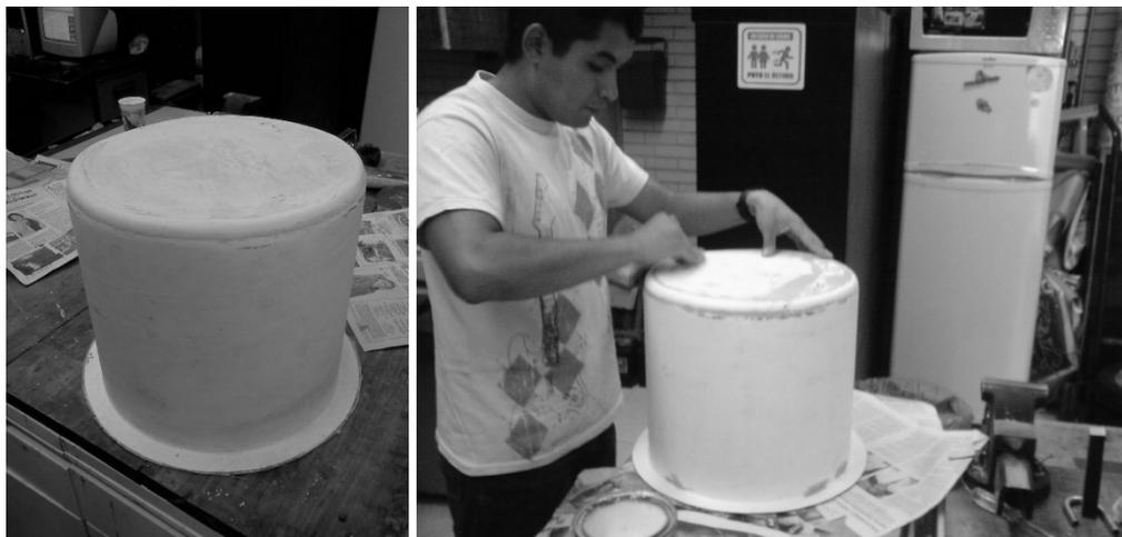
**Figura 6.3.- Molde (izquierda) y resanado del molde (derecha).**
