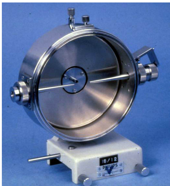
Figura 2. Cámara oscura para difracción de polvos, modelos usado por Debye y Scherrer para observar la difracción del LiF. (Fotografía del centro de investigación del museo de británico)
