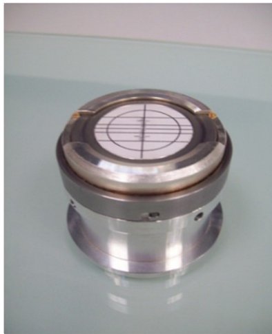
Figura 36. Muestra fluorescente montada en el porta-muestra
