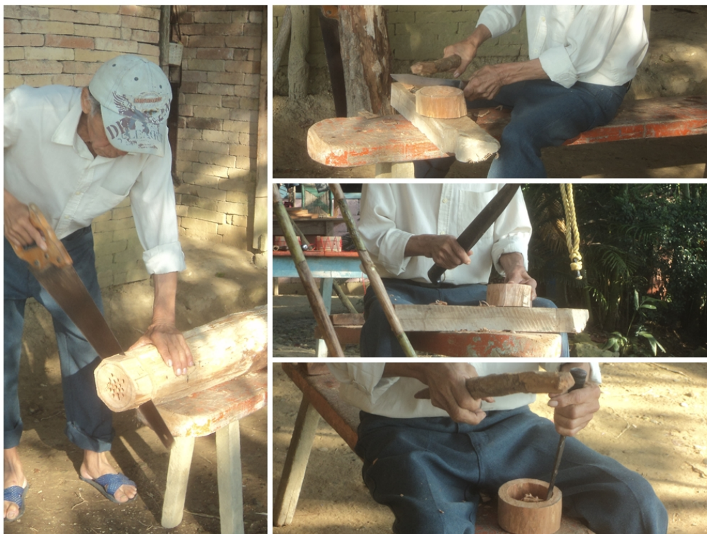
Foto 8. Construcción del cuerpo del tambor. Ernesto Bautista. Izquierda, corte de la rama de cedro. Derecha-arriba, tallado de la circunferencia golpeando un cuchillo. Derecha-en medio, tallado a pulso con un cuchillo. Derecha-abajo, vaciado interior golpeando un formón.
