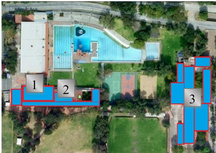
En el área 1 correspondiente a actividades deportivas se instalarán 550 colectores solares con un área aproximadamente de 2250 m<sup>2</sup>, mientras que el área 2 correspondiente a la ludoteca se instalarán 175 colectores solares con un área aproximada de 720 m<sup>2</sup> y en el área 3 (Corredor) se instalarán 275 colectores con un área aproximada de 1200 m<sup>2</sup>.
