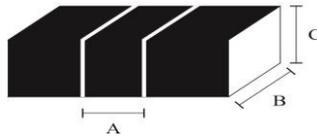
Figura 20. Dimensiones de las pastillas para las mediciones de resistividad vs temperatura.
