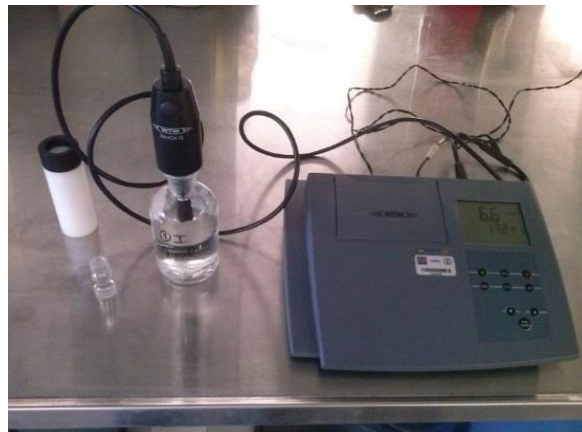
Figura 22. Determinación de OD final
