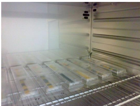
Figura 15. Tiras reactivas del sistema API-20E en incubación
