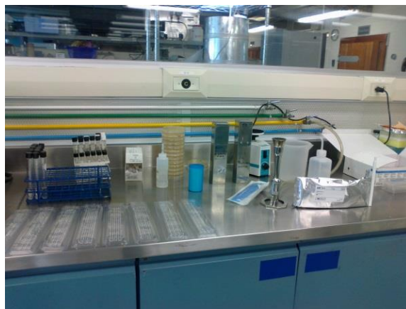
Figura 14. Equipos y materiales utilizados para el sistema de identificación API-20E
