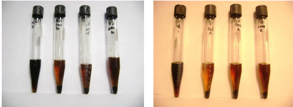
Figura 4.16. Pruebas de inhibición de agregación de asfaltenos PR con resinas PR (izquierda) y producto Zwitteriónico (derecha).
