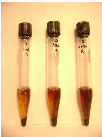
Figura 4.23. Pruebas de dispersión en el que se logra apreciar el cambio de coloración debido a la concentración de surfactante, de izquierda a derecha: 500, 1000 y 2000 ppm.
