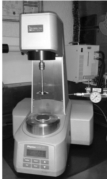
Fig. 3.9. Reómetro utilizado donde se muestra la geometría de placas paralelas.
