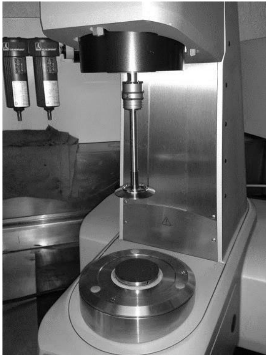
Fig. 3.9. Reómetro utilizado donde se muestra la geometría de placas paralelas.
