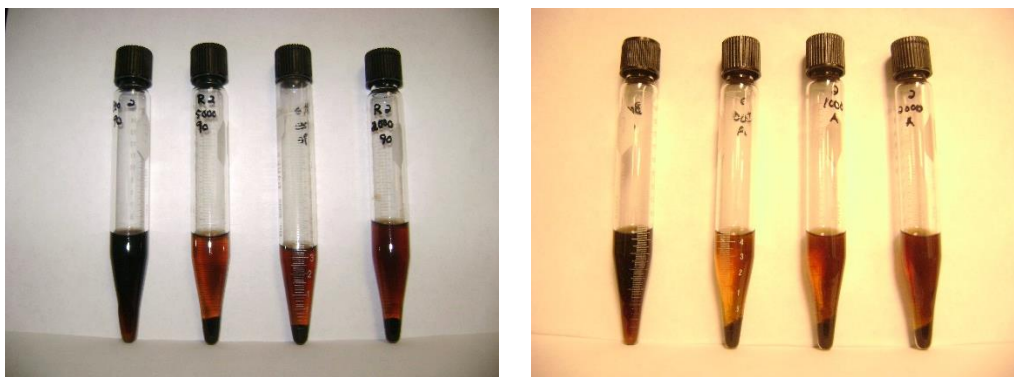
Figura 4.13. Pruebas de inhibición de agregación de asfaltenos CS con resinas CS (izquierda) y producto zwitteriónico (derecha).
