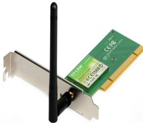
Figura 2.16 Tarjeta de red inalámbrica.
