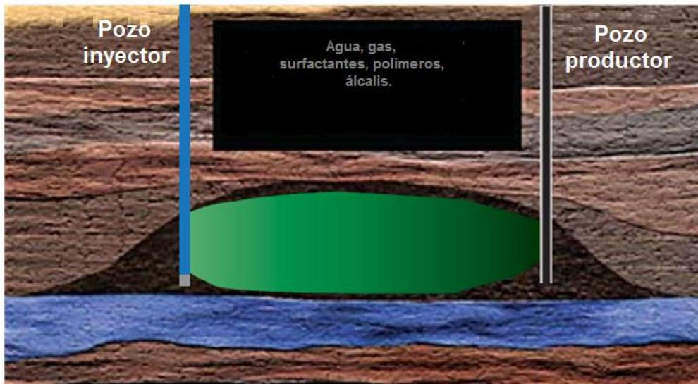
Figura 1. Barrido de petróleo remanente usando técnicas de recuperación mejorada.
