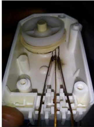
Figura 2.22. Contactos de la resistencia, compresor y común, así como leva del timer.
