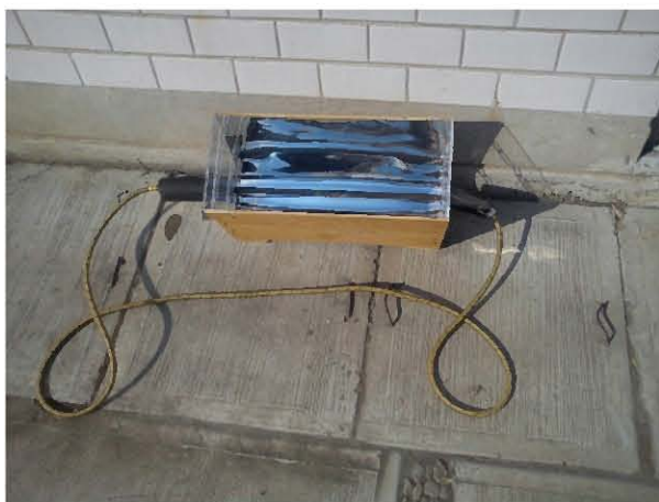
Figura 3.10 Prototipo del CPC conectado de ambos extremos con una manguera metálica de gas flexible.
