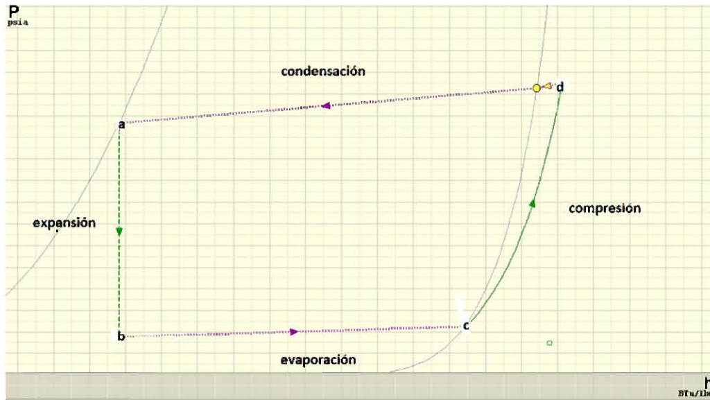
Figura 4.1 Ciclo de refrigeración por compresión en el diagrama presión-entalpía.
