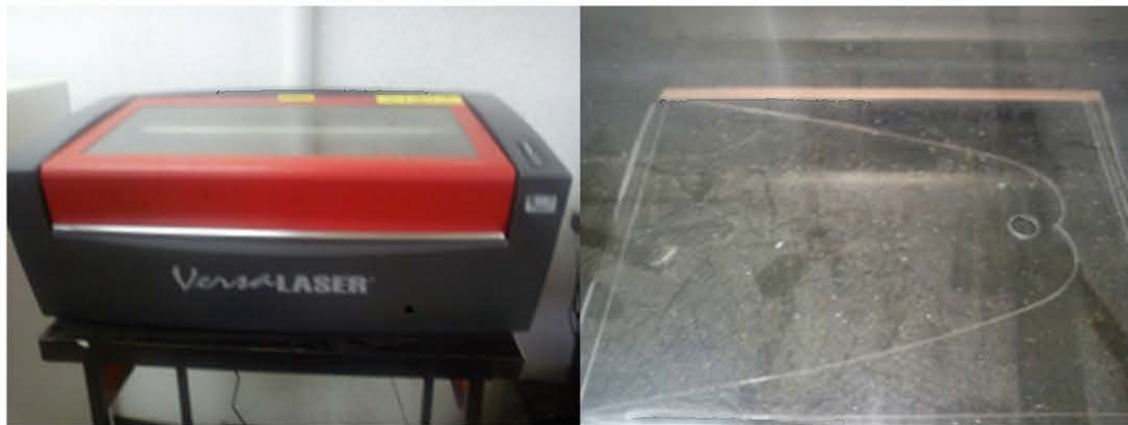
Figura 3.6. Placa de acrílico en el cortador de láser.
