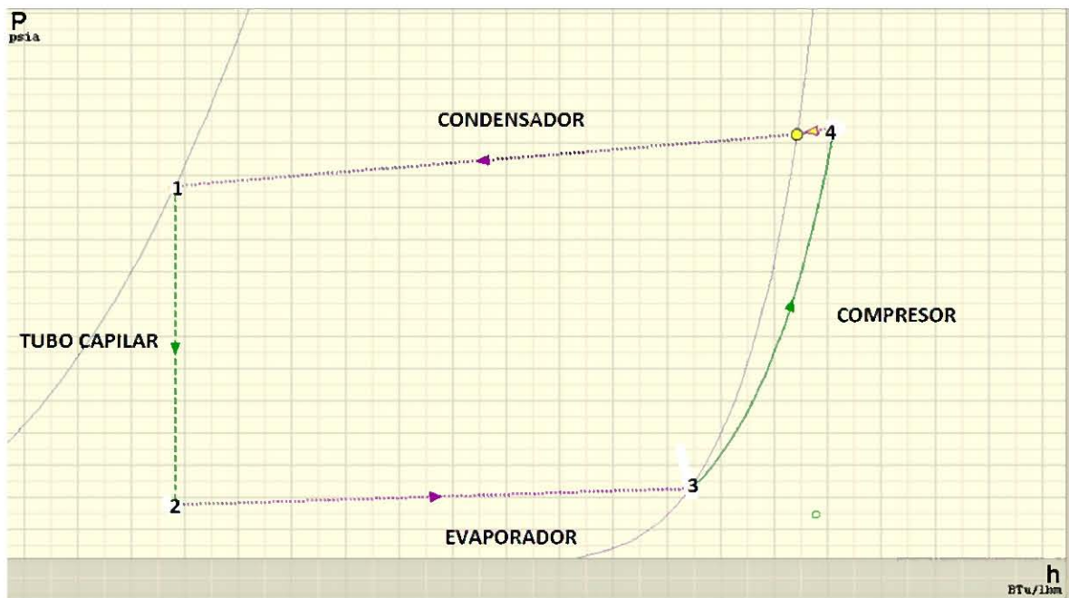
Figura 4.2 Estados del refrigerante mostrados en el diagrama presión-entalpía.
