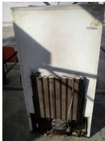
Figura 2.7. Condensador enfriado por circulación natural.
