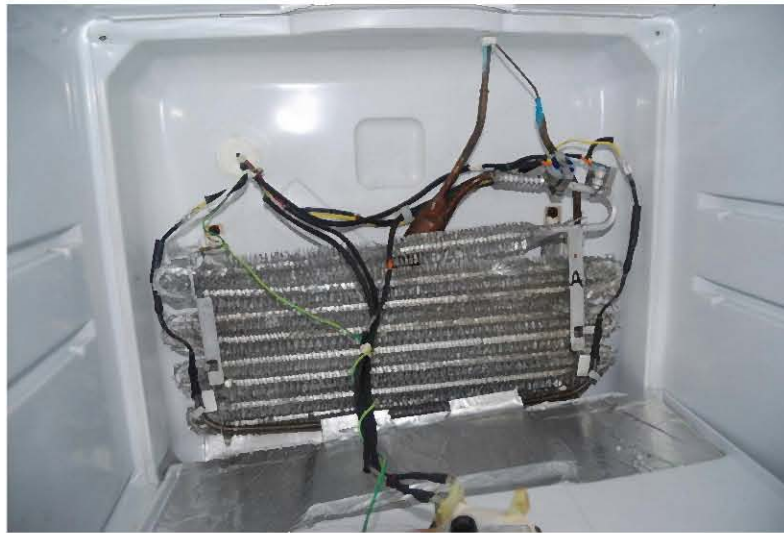
Figura 2.11. Evaporador de refrigeración doméstica del tipo no-frost.
