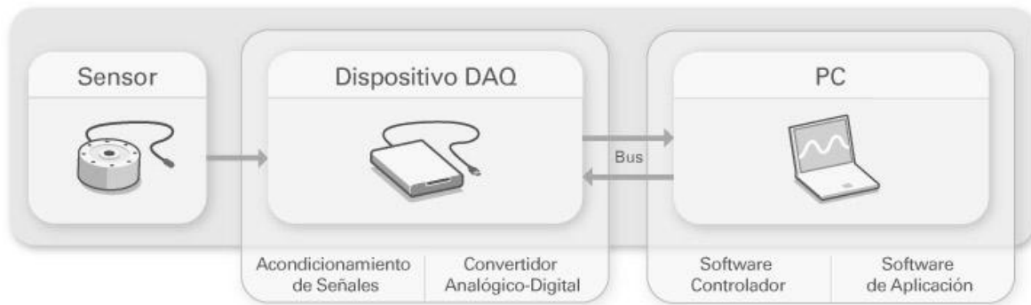
Figura I.2. Adquisición de datos en la instrumentación virtual
