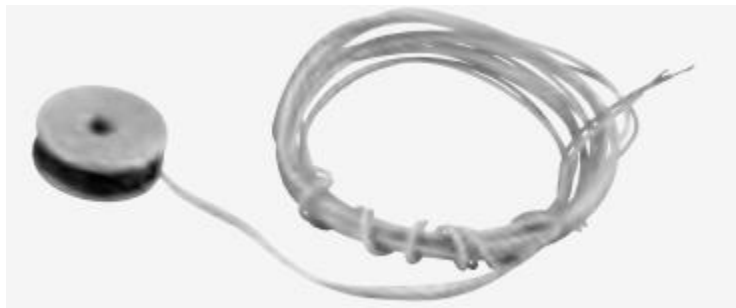
Figura IV.2-1. Sensor de temperatura criogénica modelo CY7-CY
