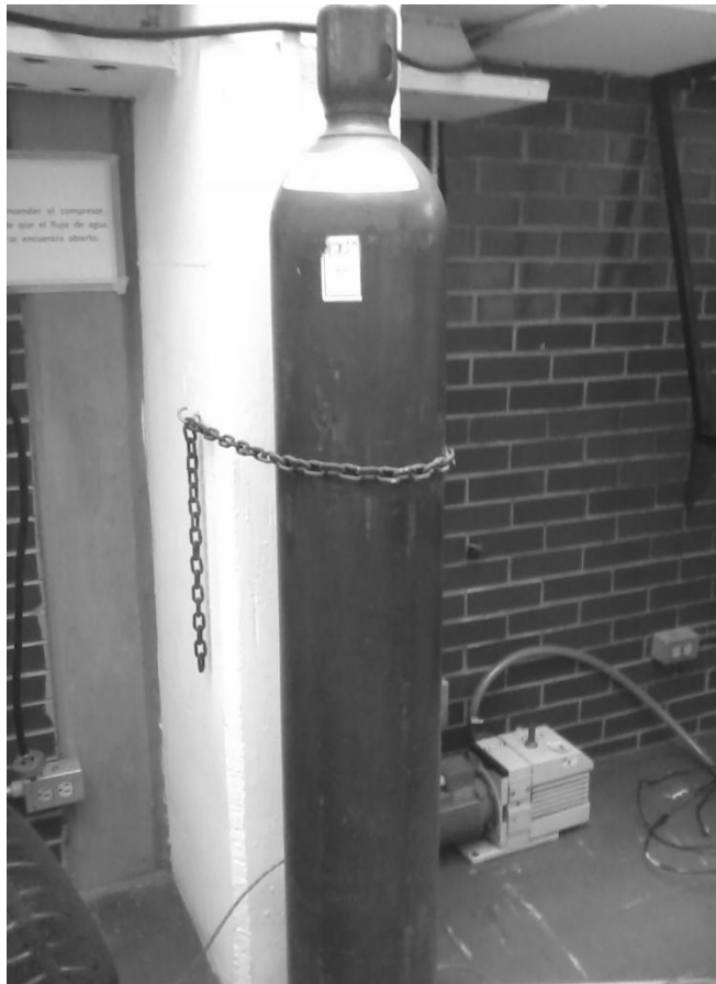
Figura IV.1-9. Fuente de gas helio
