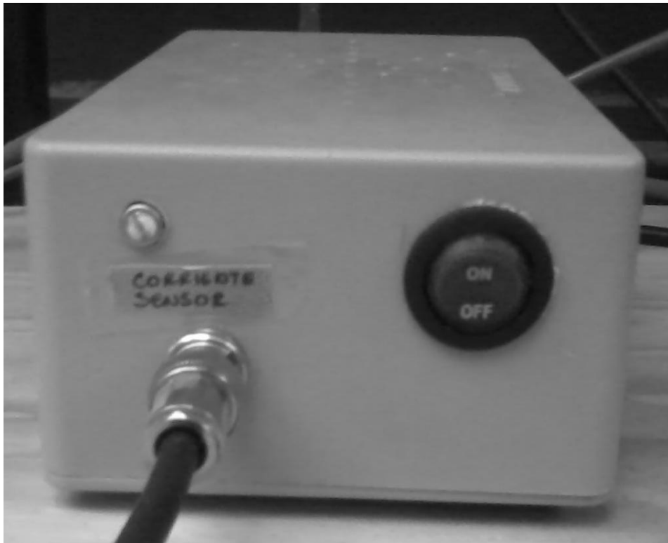
Figura IV.4-15. Fotografía de la fuente de corriente constante de 10\mu\text{A}
