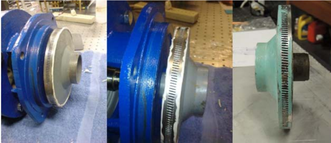
Figura 9. Imagen del impulsor de la bomba modificado
