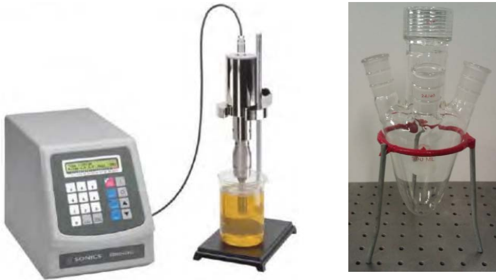
Figura 19. Imágenes del procesador ultrasónico y matraz usados para la cavitación acústica
