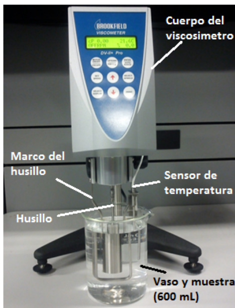
Figura 22. Arreglo experimental para medir la viscosidad y vaso con muestra en el calentador eléctrico
