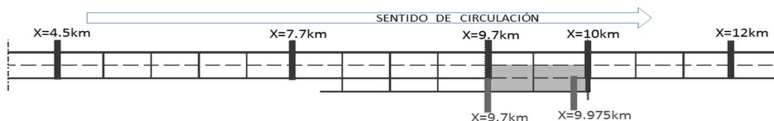
Figura 3.31 Ubicación de los detectores virtuales colocados sobre la vía principal y la rampa. El detector de la rampa que en las series de tiempo se coloca en  $x=10\text{km}$  en realidad se ubica 25 metros antes de esa posición. Lo anterior se debe a que hay vehículos que rebasen la posición  $x=10\text{km}$  sobre la rampa pues ahí termina la zona de merge.
