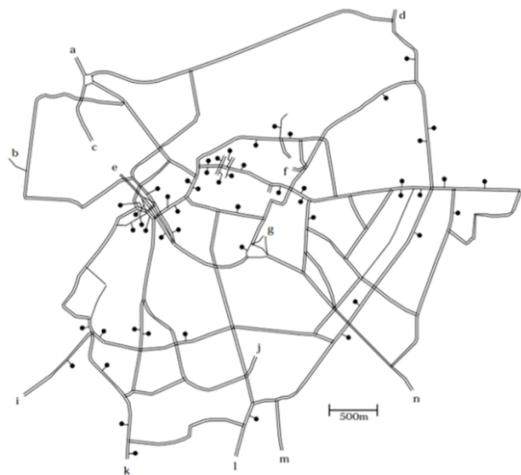
Figura 2.4 Esquema de la red vial simulada de Duisburg. Los puntos negros indican la colocación de puntos de control que se emplean en el conteo de vehículos y en la obtención de resultados
