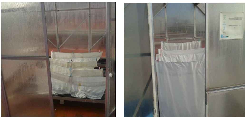
Figura 8.4. Ubicación del material poroso en las canaletas.
