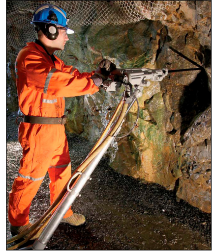
Figura 3.12 Perforadora neumática manual con pierna. [15] Boart Longyear (2012).
