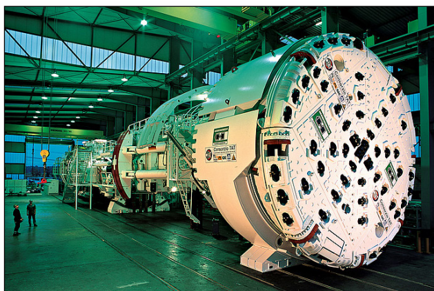
Figura 3.44 Topo de 8.83 m de diámetro, fabricado para la construcción del túnel de San Gotardo en Suiza. [93] Herrenknecht AG.
