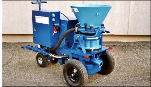
Figura 4.16 Equipo de rotor para colocación de concreto lanzado por vía seca. [96] MEYCO.
