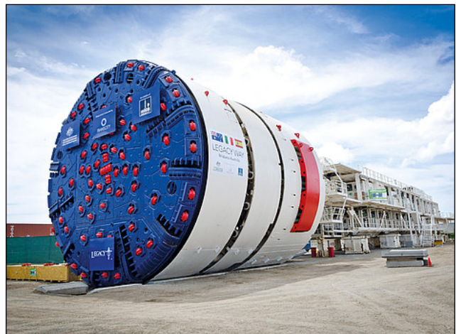
Figura 3.53 Tuneladora tipo escudo doble de 12.34 m de diámetro, utilizada en la construcción del túnel Legacy Way en Australia. [93] Herrenknecht AG.
