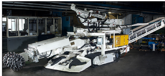
Figura 3.61 Rozadora con cabeza de corte transversal, provista de una perforadora hidráulica para anclaje. [86] Aker Wirth.
