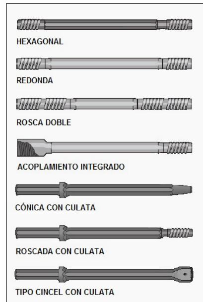
Figura 3.16 Tipos de barras. [59] López Jimeno (2003).
