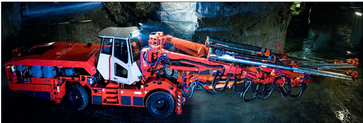
Figura 3.13 JUMBO DT1130 electro-hidráulico de tres brazos, para túneles con secciones de hasta 180 m 2 . [101] Sandvik.
