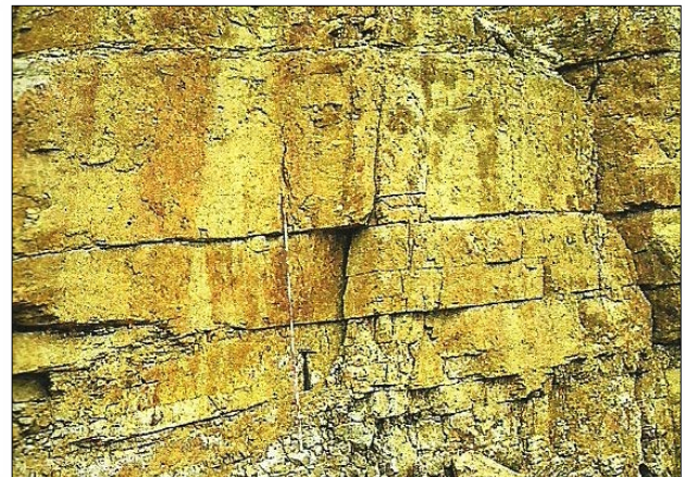
Figura 1.6 Superficies de estratificación horizontales en un macizo rocoso calizo. [43] González de Vallejo (2004).
