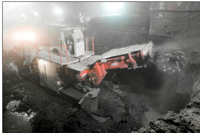
Figura 3.55 Rozadora con cabeza de corte de eje horizontal. [101] Sandvik.
