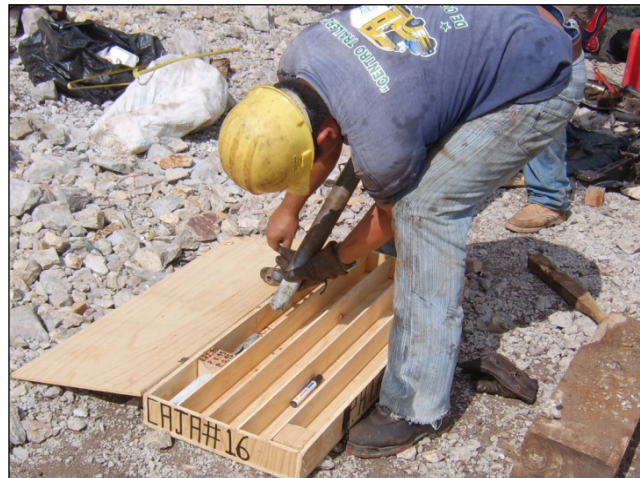
Figura 2.7 Colocación de las muestras obtenidas, en cajas de madera identificadas para su transporte y almacenamiento.
