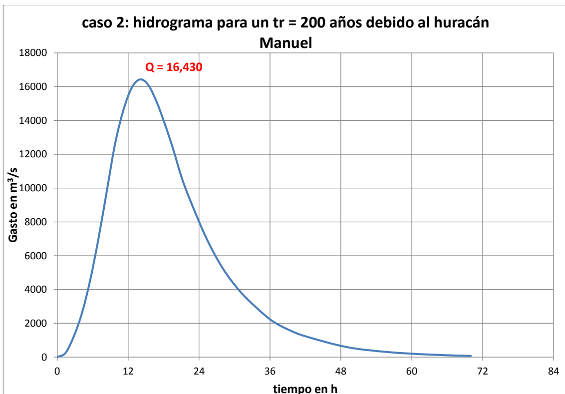
Figura 3.7. Hidrograma de diseño de la Estación hidrométrica la Parota, registros hasta el 2013 Fuente: elaboración propia
