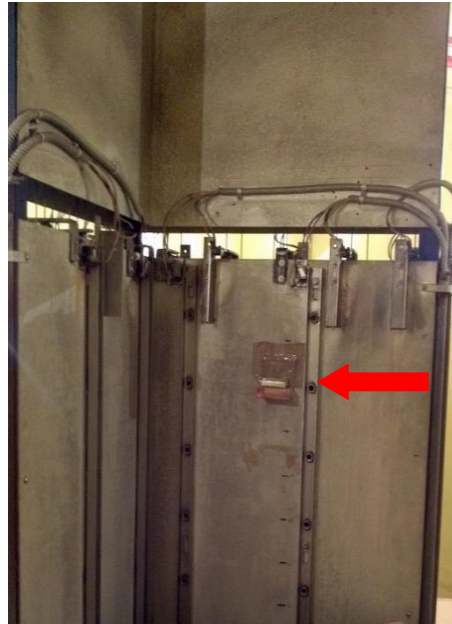
Figura 3.13.1 (a) Irradiación sobre mesa giratoria de las muestras en PSL dentro de la cámara de irradiación del irradiador Gammabeam 651PT de alberca profunda. (b) Irradiación sobre la cara del irradiador. Las flechas indican las posiciones de las muestras.
