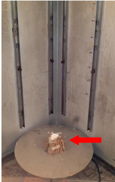
Figura 3.13.1 (a) Irradiación sobre mesa giratoria de las muestras en PSL dentro de la cámara de irradiación del irradiador Gammabeam 651PT de alberca profunda. (b) Irradiación sobre la cara del irradiador. Las flechas indican las posiciones de las muestras.
