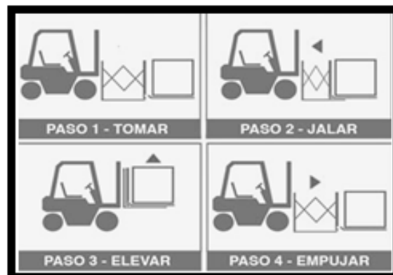
Figura 2.30 Esquema de uso de pantógrafo (LAYNESAFETY, 2009)
