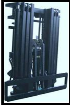
Figura 2.29 Castillo o mástil de un montacargas (Carrasco, 2011)
