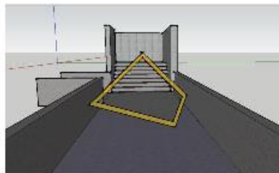
Figura 102. Vista en perspectiva cónica del objeto geométrico en plano de cuadro frontal. Breve a el trazo de la anamorfosis.
