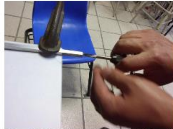
Figura 171. Fabricación de estructura principal. Elaboración de rosca interior por medio de un machuelo.
