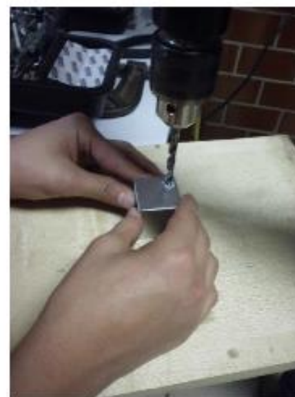
Figura 178. Perforaciones en los módulos para colocarlos en la estructura.
