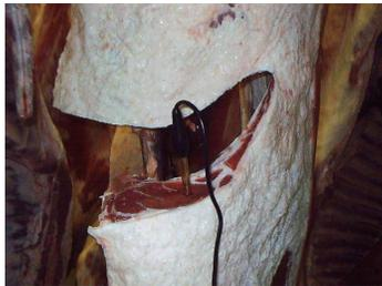
Figura 3. Medición de pH en la canal
