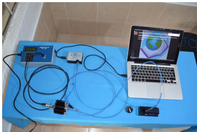
Fotografía 3.1 Fotografía del sistema de medición de fluorescencia y reflectancia difusa.
