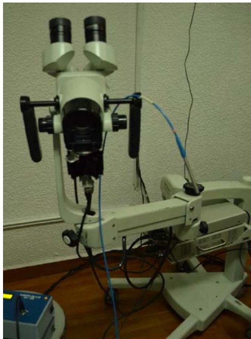
Fotografía 3.3. Sistema de iluminación acoplado al colposcopio y fibra óptica para medición de reflectancia y fluorescencia
