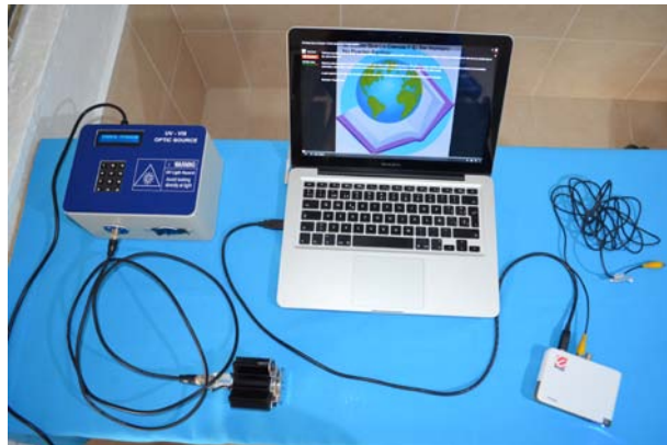
Fotografía 3.2 Fuente de luz basada en LED para iluminación y captura de imágenes del colposcopio. Esta se acopla al colposcopio a través de una platina circular de aluminio.
