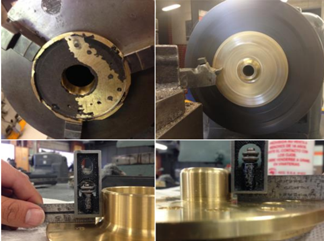
ILUSTRACIÓN VI-8 RECTIFICADO DE LAS PIEZAS
