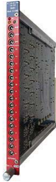
Figura 3.2: Ejemplo de un módulo usado en el estándar CAMAC . Este módulo calcula la carga generada en un detector tras la generación de una señal. De www.caen.it .
