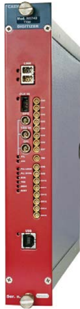
Figura 3.3: Ejemplo de un módulo usado en el estándar NIM. Este es un módulo FADC y es el usado para la adquisición de datos. De www.caen.it .
