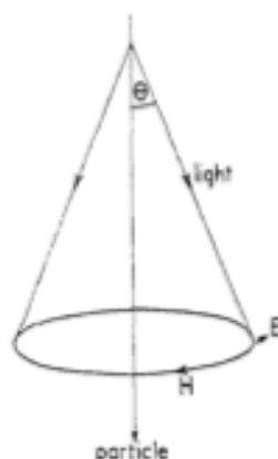
Figura 2.9: Emisión de luz Cherenkov en un medio. Se observa la distribución de los campos eléctrico y magnético sobre la superficie donde se propaga la luz.
