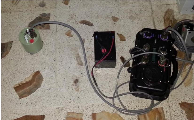
**Figura 16.** Configuración de una estación temporal para la medición de ruido sísmico en la ciudad de Coatzacoalcos, de izquierda a derecha se pueden apreciar, sismómetro Trillium Compact, batería de 12 Volts, registrador Reftek 130S y antena GPS.
