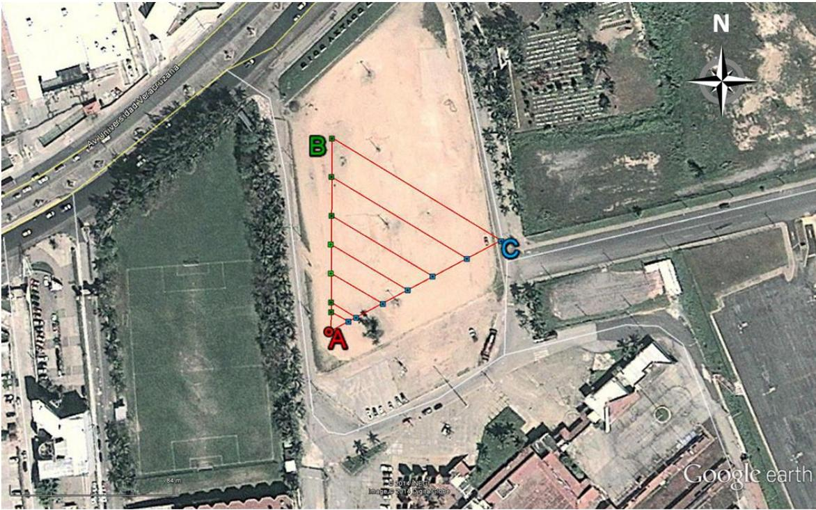
**Figura 17.** Los diferentes arreglos triangulares SPAC y la localización relativa de las estaciones temporales A, B y C.
