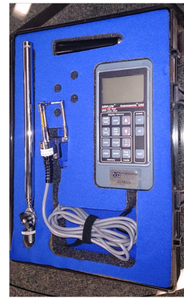
Figura 3.5: Anemómetro usado para mediciones experimentales.
