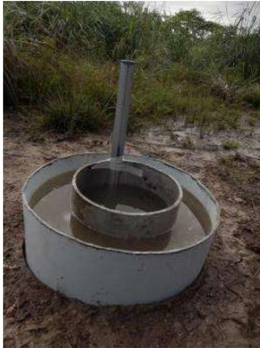
Figura 4.1.3 Prueba de infiltración INF-2
