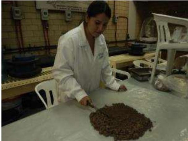
*Figura 3.3.3 Cuarteo para una muestra de suelo*
