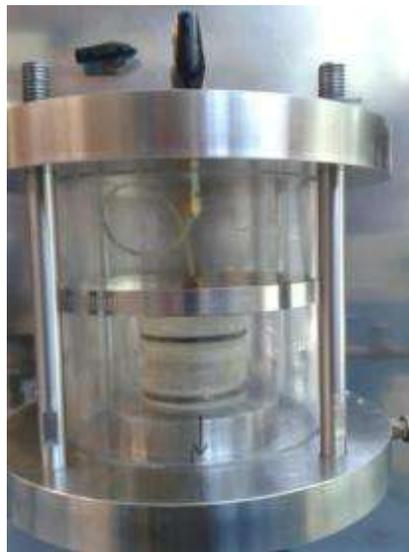
*Figura 3.2.12 Montaje de la pastilla en la cámara.*
