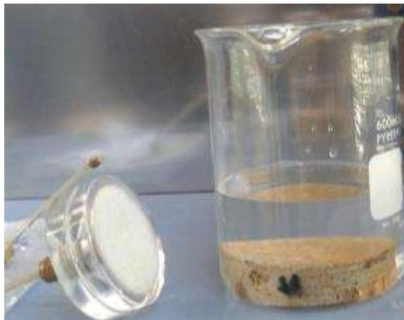
Figura 3.2.10 “Saturación” de la pastilla #16 durante 24 horas.
