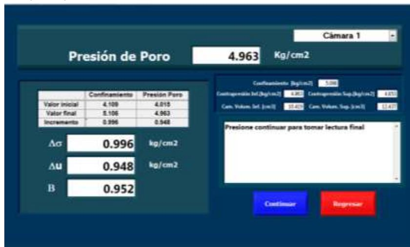
Figura 3.2.14 Ventana para calcular B de Skempton en la pastilla #16.
