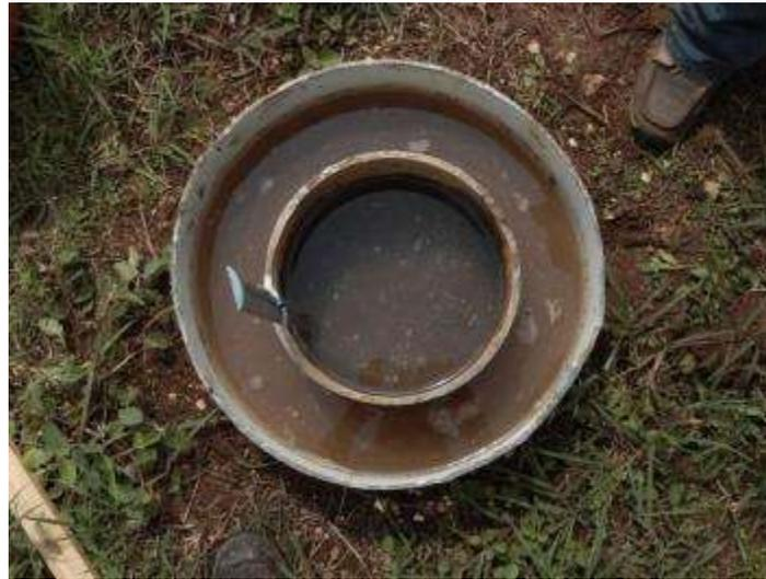
Figura 4.1.5 Prueba de infiltración en INF-3
