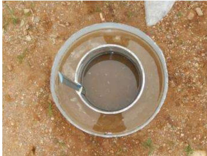
Figura 4.1.1 Prueba de infiltración en INF-1
