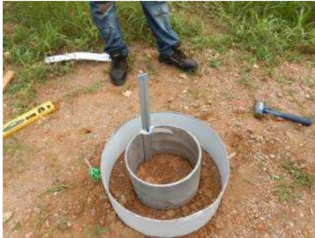
*Figura 3.1.4 Montaje final del infiltrómetro.*
