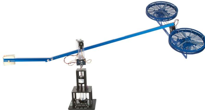
**Figura 3.1:** Helicóptero 3DoF.
