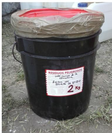
Figura 34. Contenedor tapado, sellado y etiquetado
