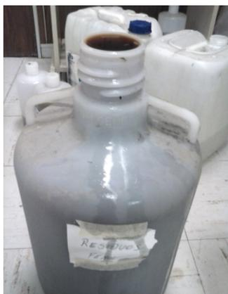
Figura 7. Contenedor sobrellenado y no identificado correctamente
