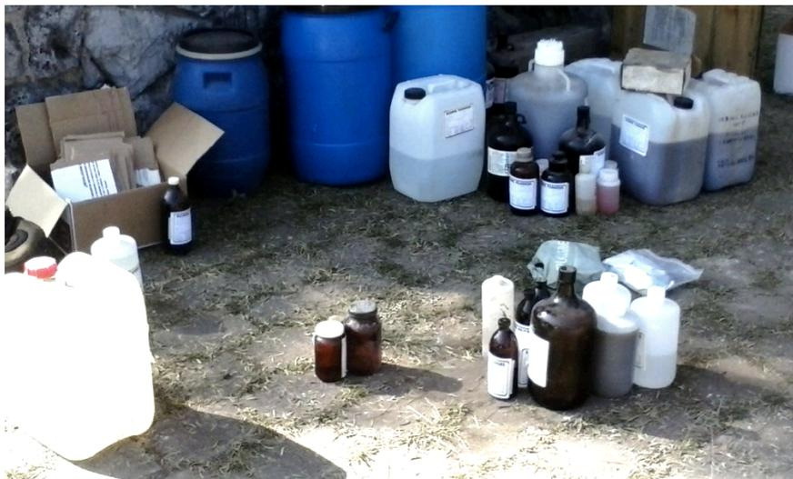
Figura 27. Separación de los residuos peligrosos por compatibilidad.
