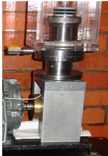
Figura 2.7: Fotografía del soporte de la columna de estudio y el acoplamiento al motor, en el segundo sistema experimental.
