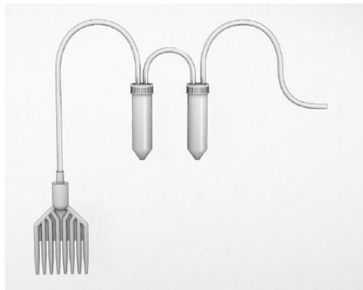
Figura 3.4. Montaje del sistema de vacío para el rompimiento y recuperación de la emulsión (Roche AppliedScience®, 2011).
