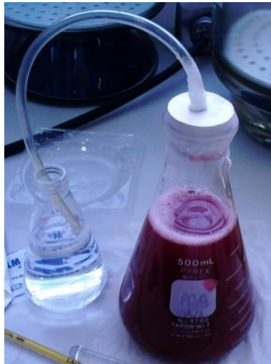
Figura 7. Preparación del matraz para la fermentación del mosto lupulado.
