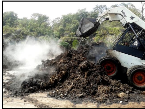
Ilustración 18. Control de temperatura mediante volteo de pilas. Planta de Compostaje UNAM
