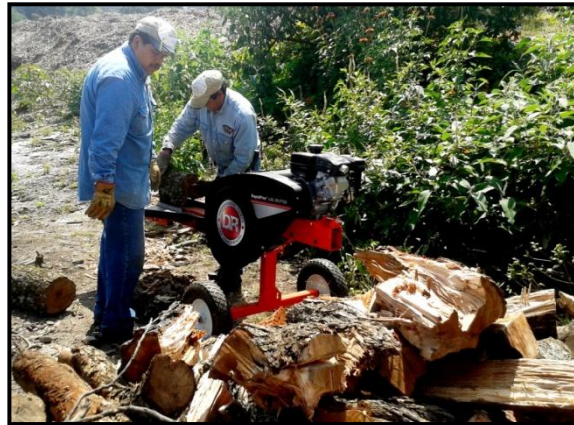
Ilustración 14. Trituración de troncos pequeños en leñadora. Planta de Compostaje UNAM
