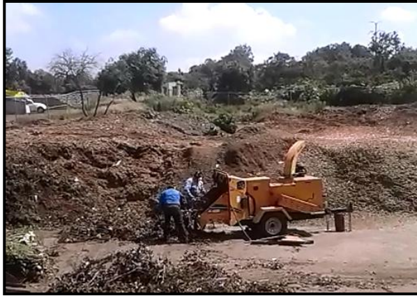
Ilustración 11. Proceso de triturado de material vegetal en Planta de Compostaje UNAM
