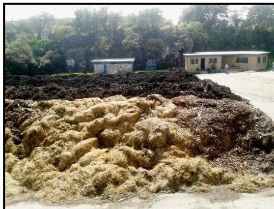
Ilustración 16. Conformación de pilas por etapa de maduración. Planta de Compostaje UNAM
