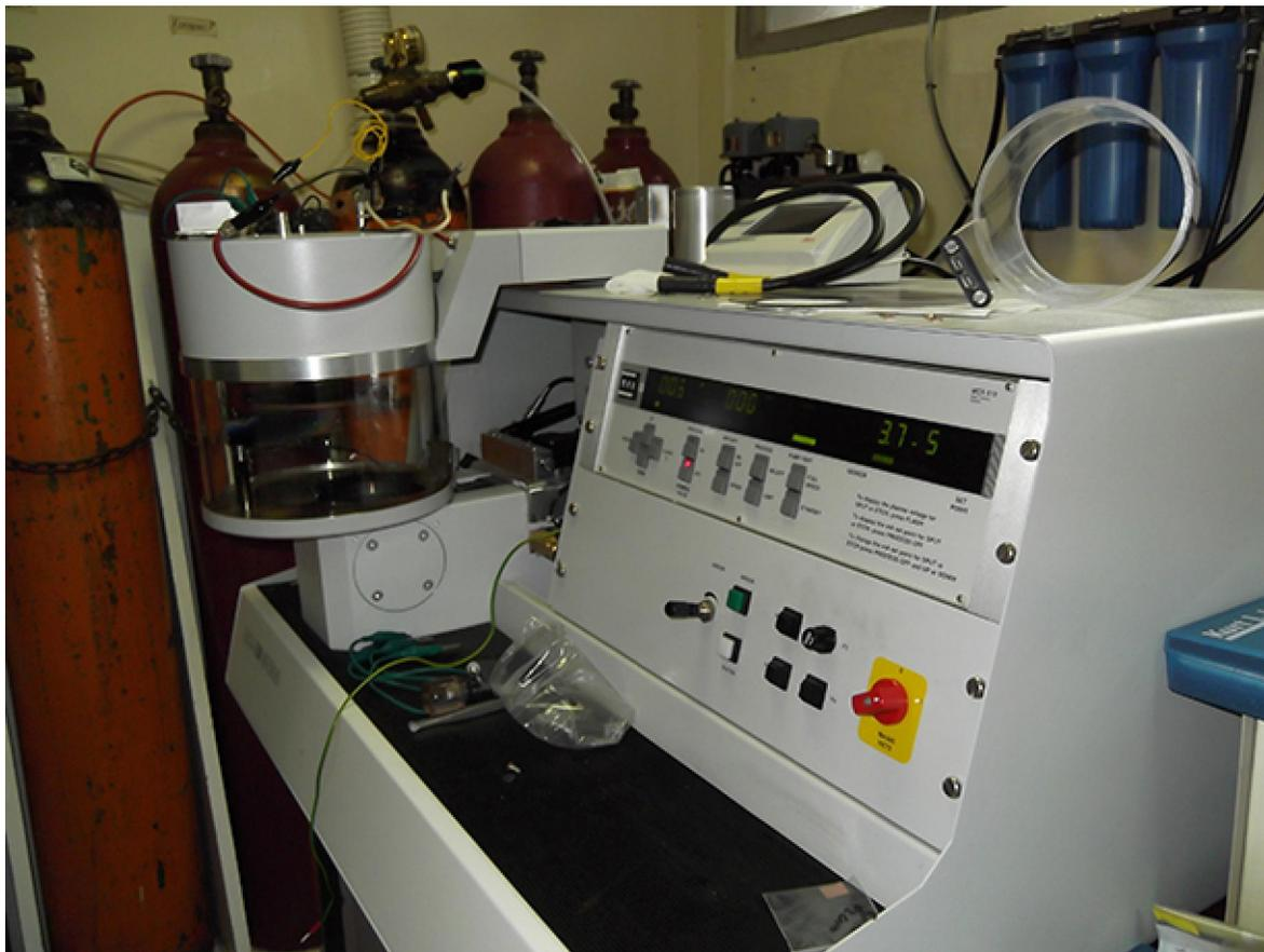
Fig. 3.1 Sputtering del cuarzo limpio en el CCADET
