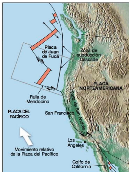
Figura 1.14 La falla de San Andrés como ejemplo de falla transformante ligada a corteza oceánica que es más joven que el fallamiento (modificado de Tarbuck y Lutgens, 2005).
