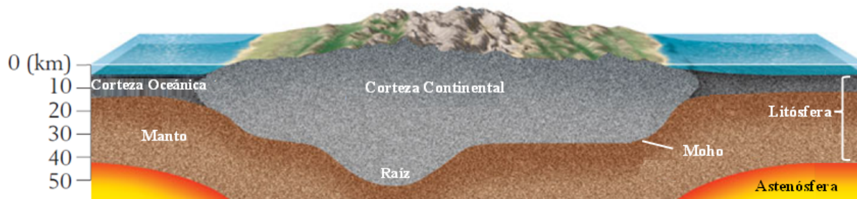
Figura 1.2 La estructura de la porción superior de la Tierra. La corteza terrestre es más antigua, menos densa y tiene un espesor mayor que la corteza oceánica, especialmente en las raíces de los orógenos. El Moho separa a la corteza del manto; el manto superior y la corteza continental se comportan mecánicamente como unidad, la litósfera (modificado de Stanley, 2009).
