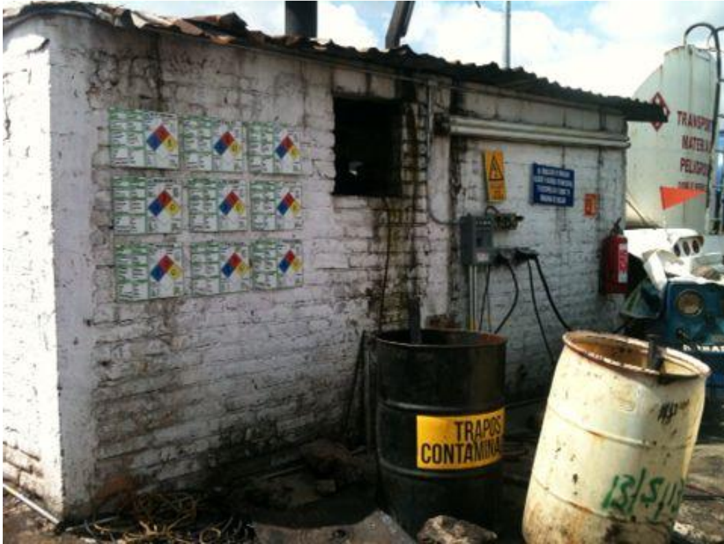
Figura 5.12 Rombos de identificación de riesgos de las sustancias con las que trabajan en Vaporizaciones.
