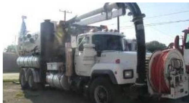
Figura 5.3. Camión vactor utilizado para absorber agua almacenada.
