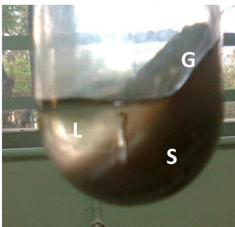
**Figura 11. Separación de fases después de 140min de centrifugación.**
