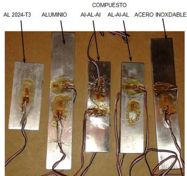
Figura C.33. Probetas individuales y compuestas instrumentadas con extensómetros
