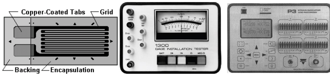
a) Extensómetro eléctrico b) Probador de extensómetros c) Puente e Wheatstone P3-Strain
